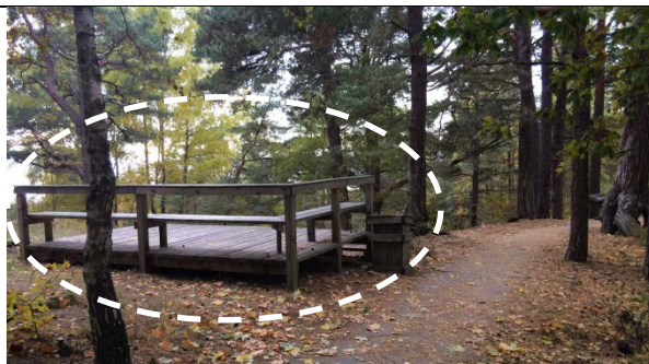
5 – Esoša koka dēļu platforma celiņa malā - ar vizuāliem defektiem - atjaunojama, veidojot sabiedriskās nozīmes atpūtas vietu. Platforma pārvietojama D virzienā, kur atklājas ainaviski vērtīgs skats uz jūru. Atkritumu urna atjaunojama. Ieteicams izretināt lapu koku sēkļaudžus galvenā skata trajektorijas atvēršanai uz jūru. Foto: E. Alle
