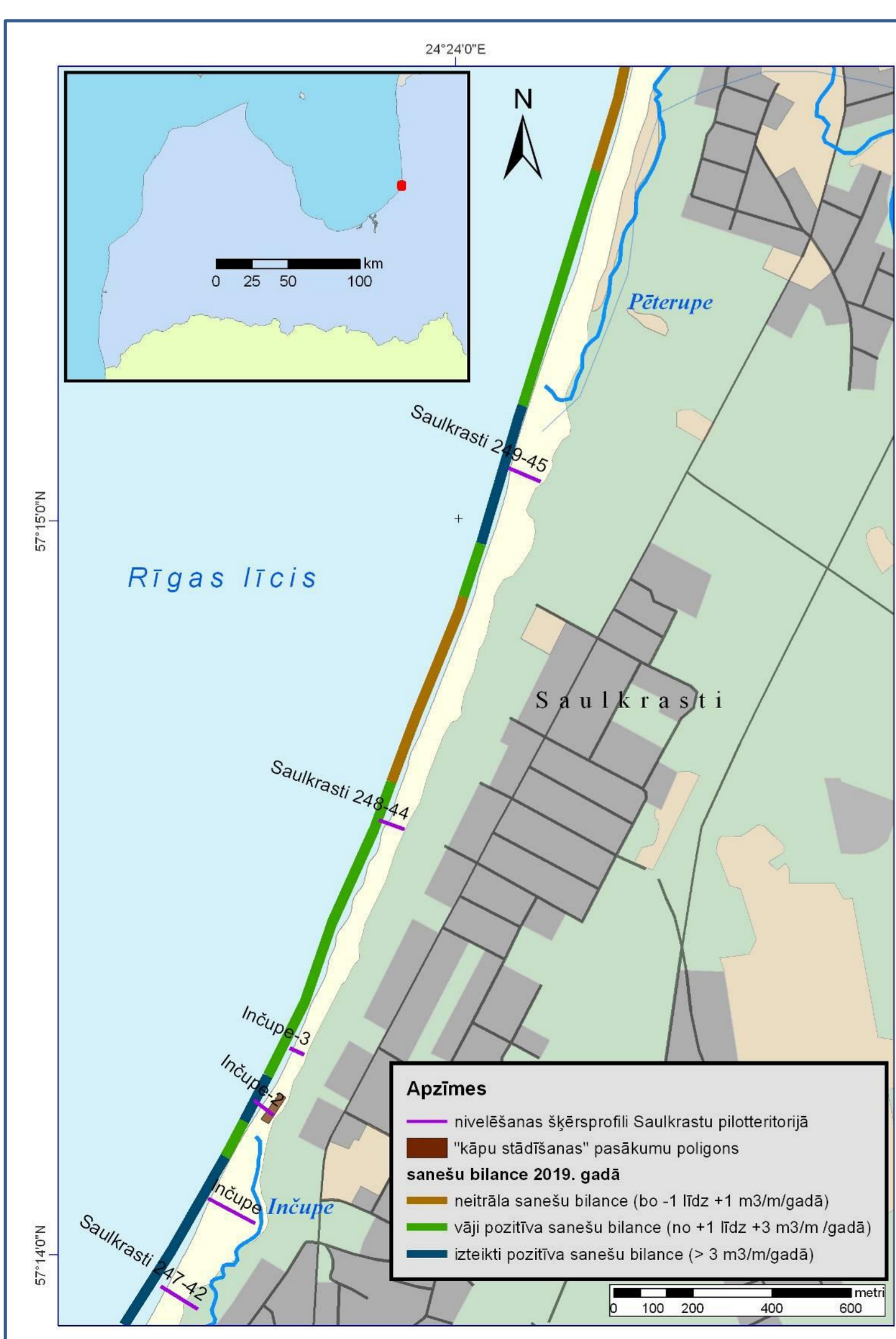
1. Attēls. Projekta Saulekrastu pilotteritorijas krasta iecirkņa sanešu bilances attēlojums (shēma) par laika periodu no 2017.10. līdz 2019.09. Sanešu bilance noteikta nivelēšanas profilos, kas aptver tikai krasta nogāzes virsūdens daļu (pludmali un primāro kāpu joslu).
