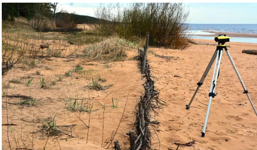
7. Attēls. Nivelēšana stacionārajā profilā „Inčupe 3”.
