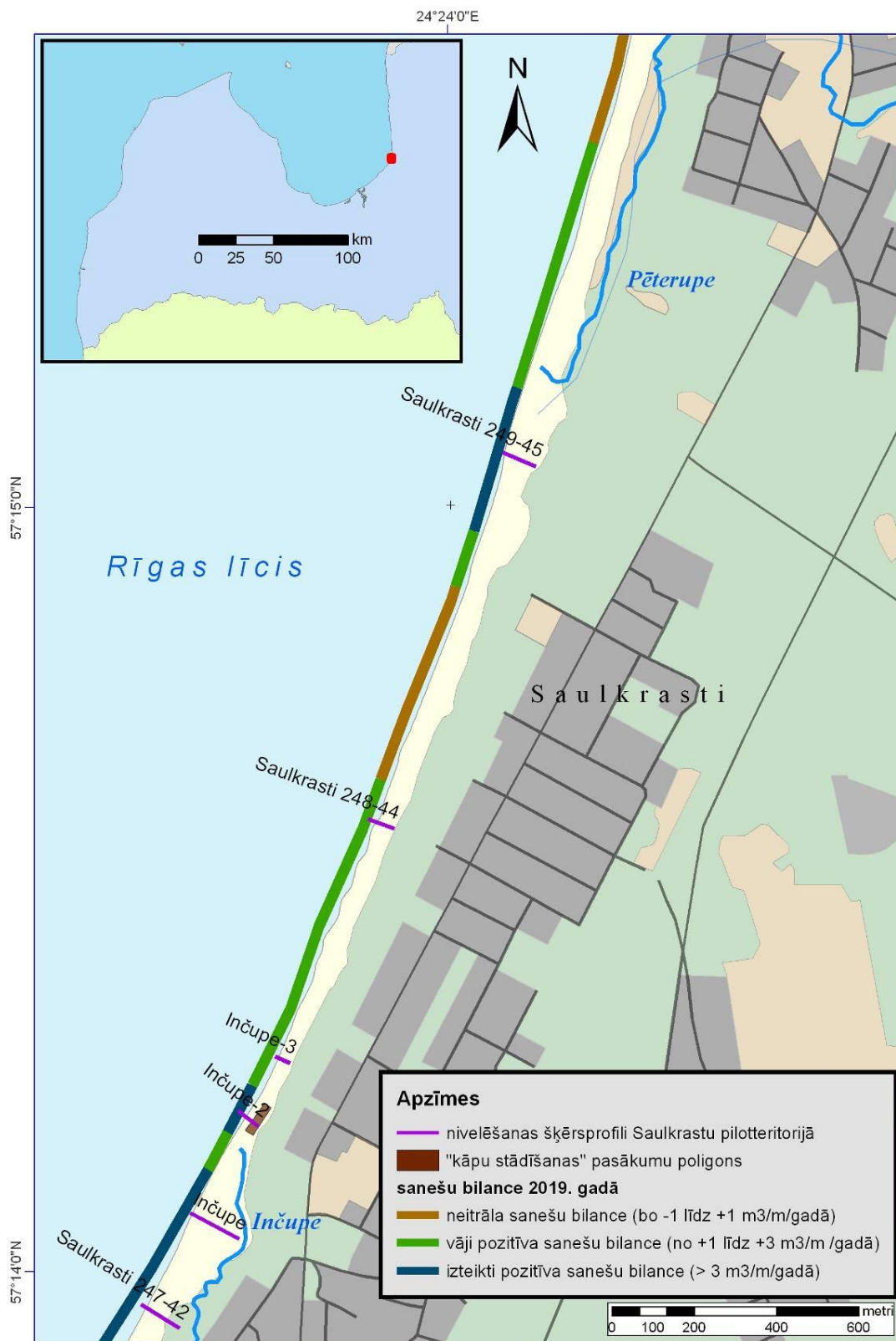
20. Attēls. Saulkrastu pilotteritorijas krasta iecirkņa sanešu bilances attēlojums (shēma) par laika periodu no 2017.10. līdz 2019.09. Sanešu bilance noteikta nivelēšanas profilos, kas aptver tikai krasta nogāzes virsūdens daļu (pludmali un primāro kāpu joslu).
