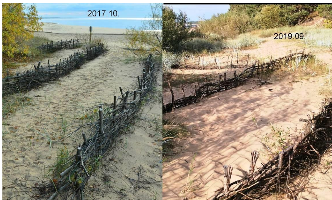
18. Attēls. Primārās kāpas atjaunošanas eksperimenta teritorijas dienvidu daļa 2017. gada oktobrī un 2019. gada septembrī. Dziļāk iekšzemē esošo žogu tuvumā smilšu uzkrāšanās notiek nelielā apjomā, tomēr žogu klātbūtne uzlabo teritorijā esošo priekšējai raksturīgo augu sugu „izdzīvošanas” iespējas. Žogu stāvoklis 2,5 gadus pēc to ierīkošanas ir apmierinošs.
