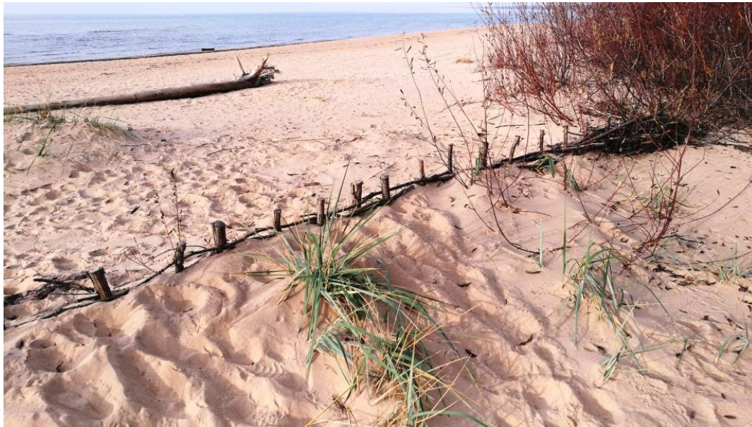
15. Attēls. Primārās kāpas atjaunošanas eksperimenta teritorijas ziemeļu daļa 2018. gada oktobrī (skats uz ziemeļiem). Neskatoties uz ļoti intensīvu 2018. gada vasaras atpūtas sezonu un lielu pludmales apmeklētāju pieplūdumu, žogs un daļa no kāpu graudzāļu stādījumiem ir saglabājuši savu funkciju – nav būtiski bojāti un nodrošina smilšu uzkrāšanos.
