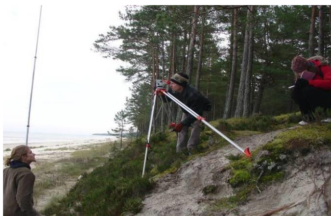
2. Attēls. Nivelēšana stacionārajā profilā.
