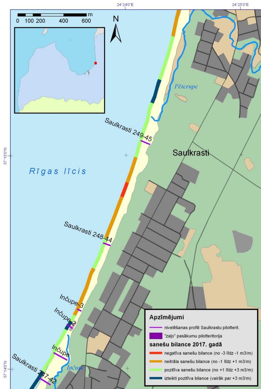
8. Attēls. Saulkrastu pilotteritorijas krasta iecirkņa 2017. gada sanešu bilances attēlojums (shēma). Sanešu bilance noteikta nivelēšanas profilos, kas aptver tikai krasta nogāzes virsūdens daļu (pludmali un primāro kāpu joslu).
