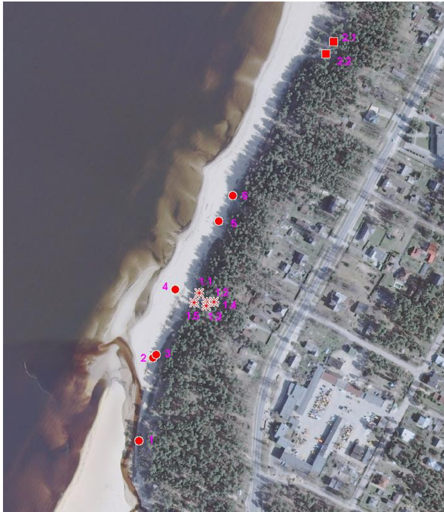
2.1.1.att. Visu kārkļu pinuma žogu izvietojuma kartoshēma Saulkrastu pilotteritorijā (izmantota 2013.gada ortofoto pamatne; apzīmējumi - ● žogu pinumu posmu sākumpunkti, * nogāžu pinumi Nr.1, ■ nogāžu pinumi Nr.2).
